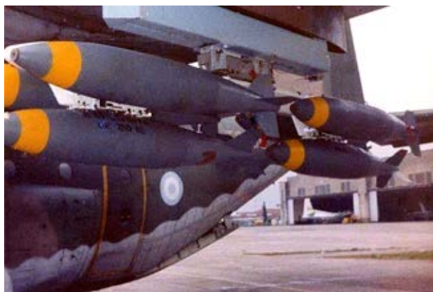
Las seis bombas Alaveses de 250 Kg. colgadas de un (MER) Múltiple Ejector Rack bajo el ala izquierda del TC-68 (foto: vía Fundación Marambio).
