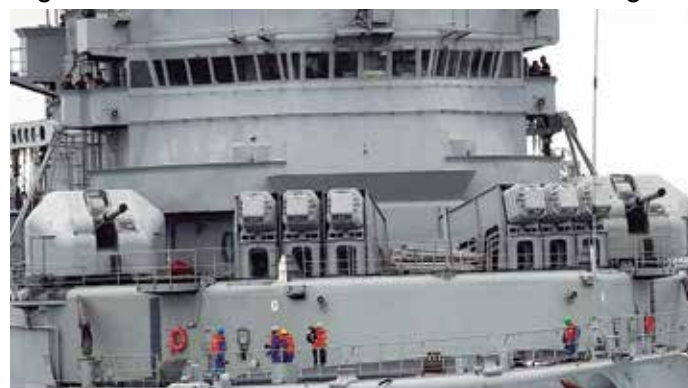
Montaje de 6 unidades contenedor-lanzador de misiles Exocet MM-38 en el buque francés Jeanne d'Arc (R97)
