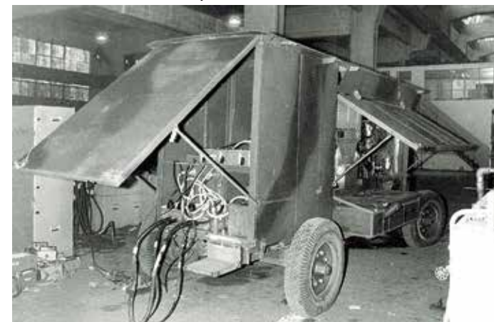
Unidad que incluye los equipos electrónicos de control de tiro y el grupo electrógeno de la batería terrestre de misiles Exocet (ITB), dentro del Taller de Misiles de Puerto Belgrano (Mayo de 1982) - Fuente: Carlos Ríos Centeno
