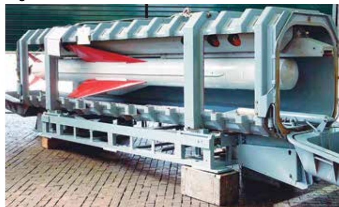
Corte de una unidad contenedor-lanzador de misiles Exocet Mar-Mar, que se instala en un buque
