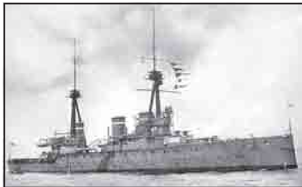
El crucero de batalla HMS Invencible. Poseía una potencia de fuego, blindaje y velocidad netamente superior a cualquier crucero acorazado. El HMS Inflexible era de la misma clase. Su armamento principal eran 8 cañones de 305 mm y desarrollaba una velocidad de 25 nudos.
